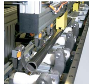
Lunette de guidage LF Sur la photo: lunettes ouvertes et portail de chargement intégré à console magnétique
