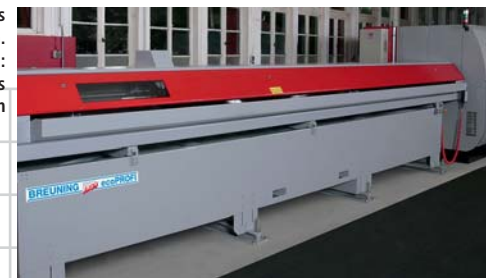
PROFMat pour des barres longues de 6 m. Photo: Diamètre des barres jusqu'à 50 mm
