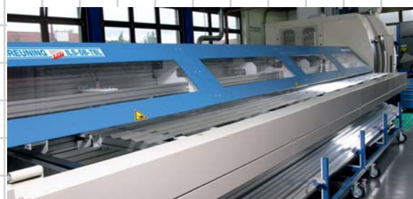
ILS-SB-TBL pour profilés extrudés longs de 6 m. Photo: Diamètre des barres jusqu'à 130 mm
