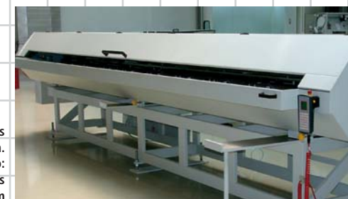
ILS-SB-TBL pour profilés extrudés longs de 6 m. Photo: Diamètre des barres jusqu'à 130 mm
