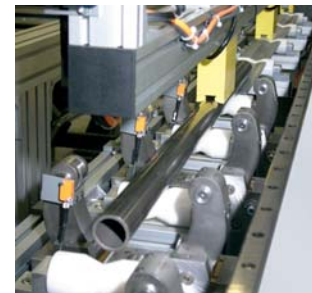
Lünettenführung LF Im Bild: geöffnete Lünetten und integriertes Ladeportal mit Magnethalter
