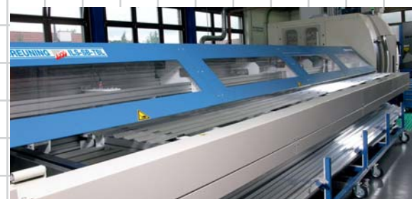
ILS-SB-TBL für 6 m lange Strangpressprofile. Im Bild: Werkstück-Ø bis 130 mm
